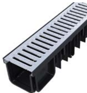
KORYTKO PP Z KRATKĄ ZE STALI OCYNKOWANEJ 130/50 [1M] certyfikowane na klasę obciążenia B125 – do 12,5 t wymiary: szerokość 134 mm wysokość 81 mm głębokość 50 mm długość 1000 mm
