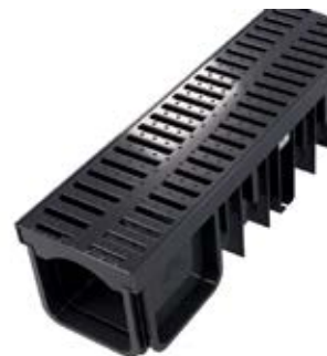
KORYTKO PP Z KRATKĄ Z POLIPROPYLENU 130/90 [0,5M] -CERTYFIKOWANY NA KLASĘ OBCIĄŻENIA A15 – DO 1,5 T certyfikowane na klasę obciążenia B125 – do 12,5 t wymiary: szerokość 134 mm wysokość 121 mm głębokość 90 mm długość 500 mm
