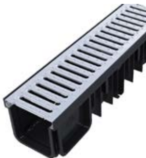
ZE STALI OCYNKOWANEJ 130/90 [1M] certyfikowane na klasę obciążenia B125 – do 12,5 t wymiary: szerokość 134 mm wysokość 121 mm głębokość 90 mm długość 1000 mm
