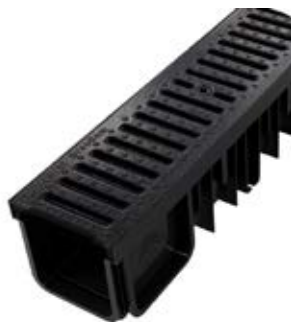
KORYTKO PP Z KRATKĄ ŻELIWNĄ 130/90 [0,5M] certyfikowane na klasę obciążenia B125 – do 12,5 t wymiary: szerokość 134 mm wysokość 121 mm głębokość 90 mm długość 500 mm
